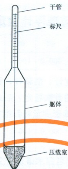
图 1 玻璃浮计结构示意图
