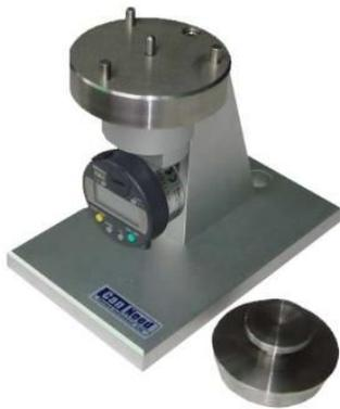
4.2.1 开机（按 DATA 键开机，按 MODE 键选择单位 mm，按 SET 键显示数字后，按 SET 键显示“+××××.××”时，再按住 SET 键直到+号开始闪烁，按 MODE 键改变数字，按 SET 键移动闪烁光标，直到所有数字和标准棒上的数字相同时，按 SET 键两次，取下标准棒，进入测量状态）：
